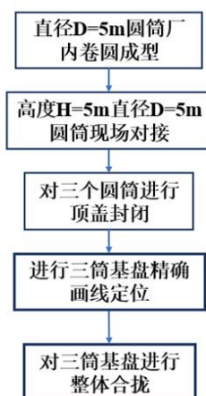
图 1.6-1 三筒基盘整体施工建造流程
