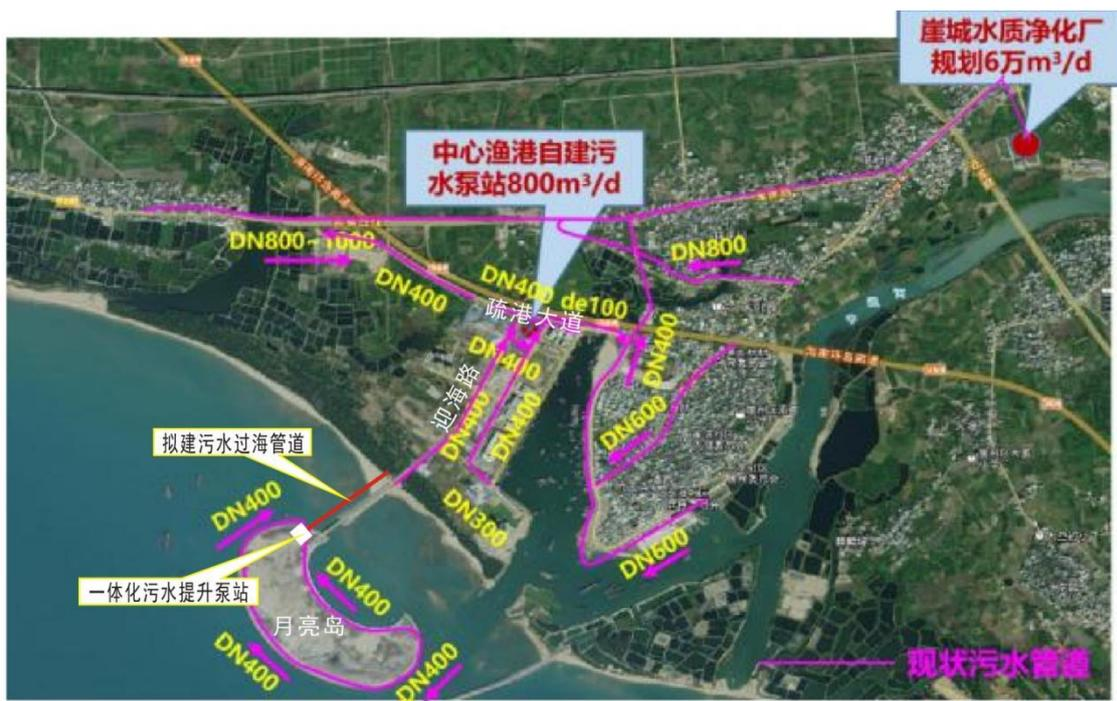
图 1.1-3 拟建过海污水管道示意图
