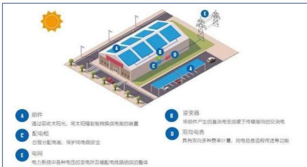
图 5-2 光伏电站构成示意图
